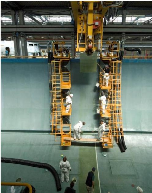
Le sovrastrutture sono invece realizzate in configurazione “sandwich” (ossia con due strati in fibra di vetro e fibra di carbonio che racchiudono un’anima in balsa), e sono state costruite con la tecnica dell’infusione sotto vuoto, già sperimentata con successo da Intermarine per la costruzione delle motovedette da 13 metri e per i ponti di coperta dei pattugliatori da 28 e 36 metri, ma utilizzata per la prima volta per la realizzazione di grandi sovrastrutture di cacciamine.
