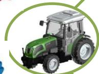
La novità del progetto, sviluppato con la collaborazione di 4e consulting, consiste nella realizzazione di un sistema che integra un motore endotermico *downsized* a ciclo diesel e un motore elettrico come propulsori di un veicolo da 105CV con l'obiettivo principale di consentire un utilizzo razionale della potenza erogata in funzione delle diverse necessità delle lavorazioni.
