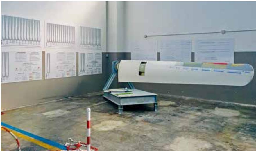
L'addestramento prevede una parte teorica sulle diverse tipologie di gear box e sull'interpretazione dei danni rilevabili, oltre a una parte prettamente tecnica sull'utilizzo del videoscopio all'interno di un gear box appositamente allestito.
