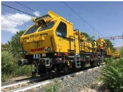
Figura 10 – Mezzo d'opera per l'installazione della catenaria
