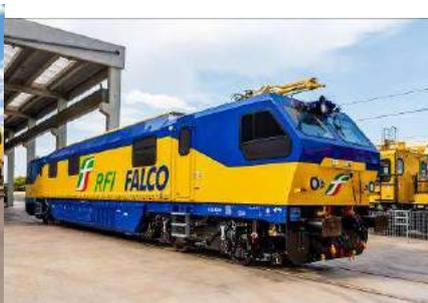
Figura 12 – Veicolo diagnostico per il binario e per la catenaria
