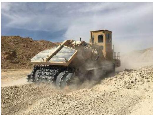
Figura 6 – *Surface Miner con rullo di scavo – Rock Hawg*
