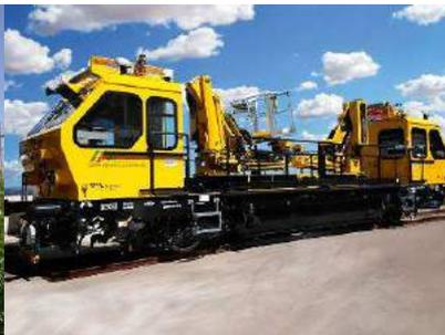
Figura 11 – Unità multifunzione per la manutenzione della catenaria
