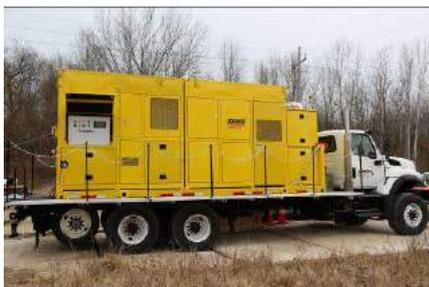
Figura 1 – Progetto di *reconductoring* in Michigan City, Indiana, linea di trasmissione 138 kV, eseguito dalla società Michaels con macchina *Continuous Linear Puller (CLP)* – 2020
