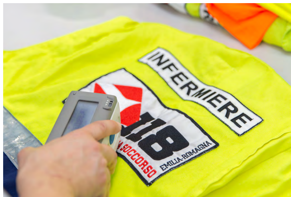
Controllo di un dispositivo ad alta visibilità
