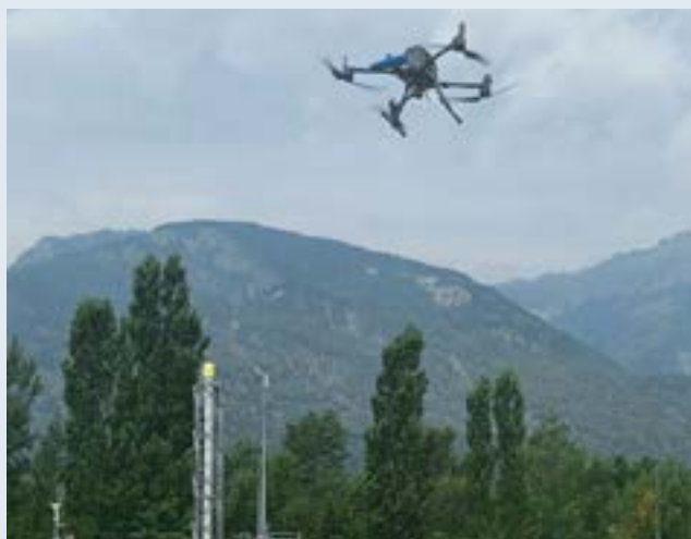
Figura: Test di misurazione delle emissioni di metano tramite strumentazione montata su droni
