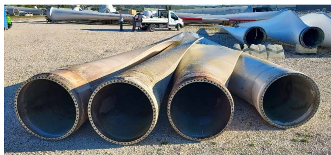
Nella foto le quattro pale V47 destinate ai test su scala pilota industriale
